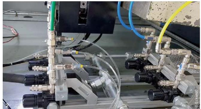
1 Für die MMS sorgen hochpräzise Dosieranlagen. 2 Qualität ist für Eckardt das A und O; ausführliche Tests gingen der Inbetriebnahme voraus.
