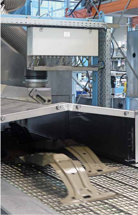
Die Produkte sind am Ausgang der Anlage optimal beölt, unabhängig von ihrer Geometrie. Dafür sorgen die Sprühdüsen, die sich in alle Richtungen bewegen und bei Schwenkwinkel und Ölmenge stufenlos anpassen lassen.
