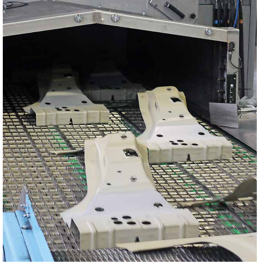
Die Produkte sind am Ausgang der Anlage optimal beölt, unabhängig von ihrer Geometrie. Dafür sorgen die Sprühdüsen, die sich in alle Richtungen bewegen und bei Schwenkwinkel und Ölmenge stufenlos anpassen lassen.
